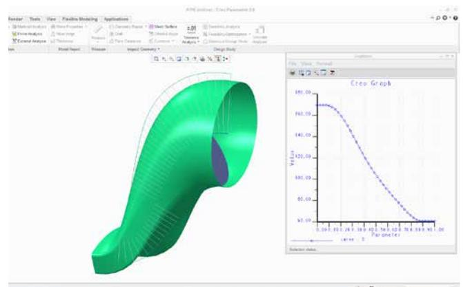
Die Ermittlung des gewünschten Querschnittsbereichs entlang einer Kurve nach dem Versuch-und-Irrtum-Prinzip kann sehr zeitintensiv sein. Mit PTC Creo BMX ist sie hingegen ganz schnell und einfach durchzuführen.
